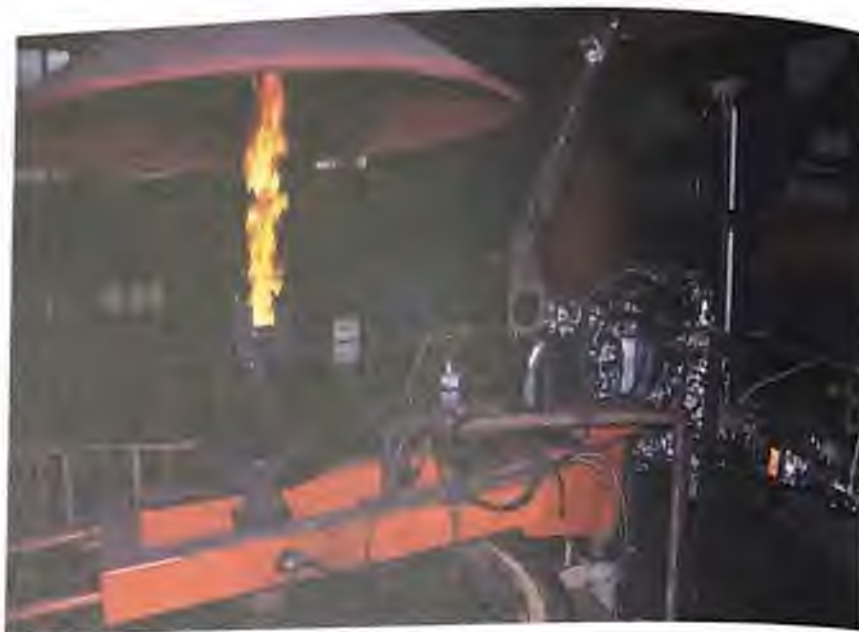
Рис. 1. Традиционное сжигание газовых выбросов после электропечи термической обработки заготовок
