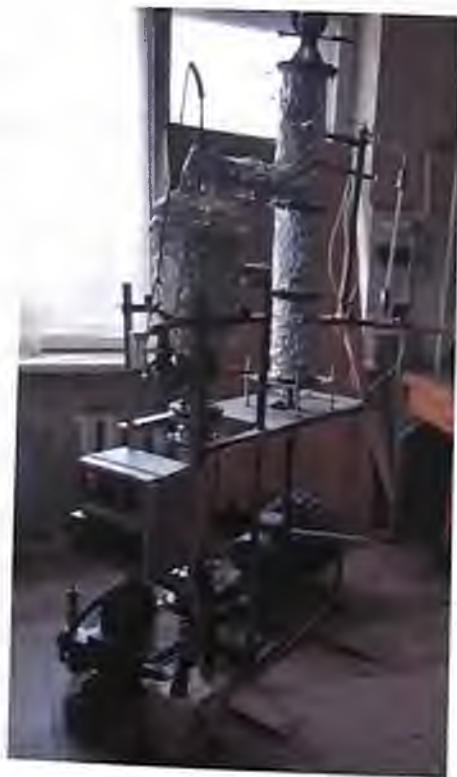
Рис. 7. Лабораторная установка термического обезвреживания сточных вод в процессе проведения испытаний
