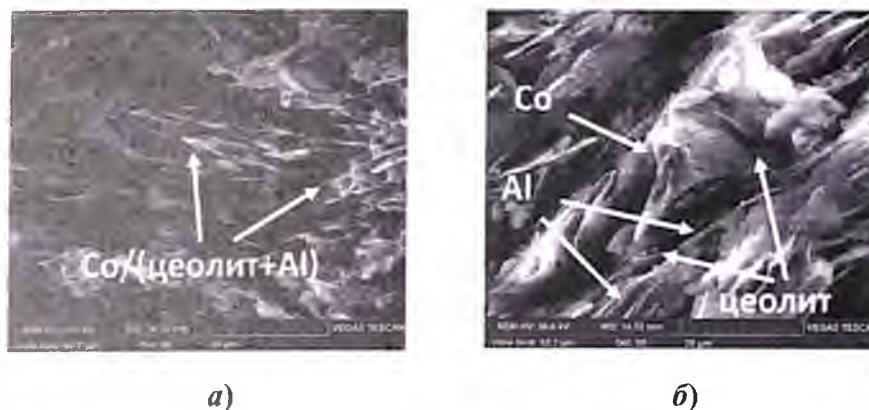
Рис. 1. Электронные микрофотографии поверхности катализаторов Co/HB (а) и Co–HB (б)
