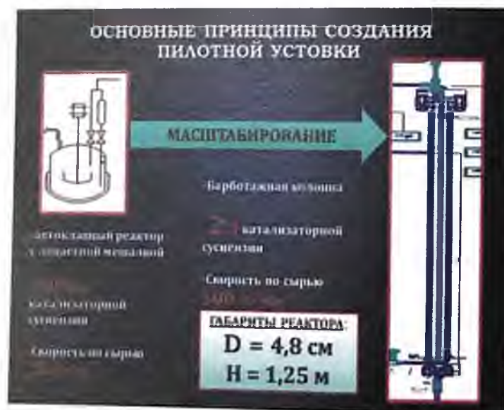
Рис. 9. Основные габариты трехфазного реактора для осуществления синтеза Фишера-Тропша в присутствии каталитических дисперсий
