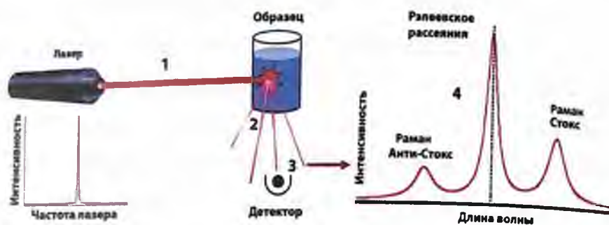
Рис. 2. Принцип лазерного возбуждения Рамановского спектра
