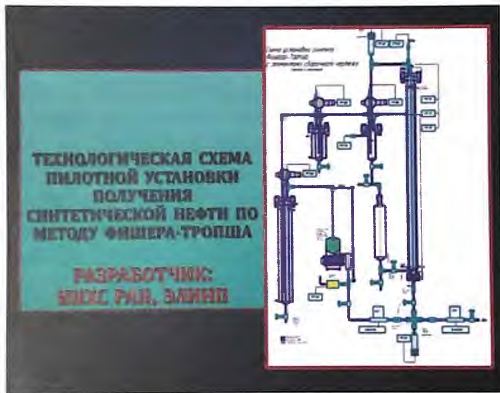
Рис. 7. Технологическая схема пилотной установки трехфазного синтеза Фишера-Тропша в присутствии железосодержащих каталитических дисперсий
