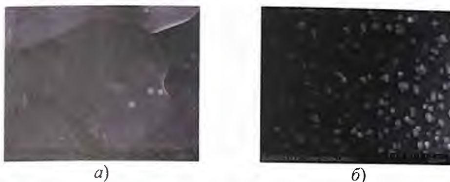
Рис. 12. Изображения поверхности KCoMoS-кат-ра с увеличением в 50 тыс. раз (а) и в 200 тыс. раз (б), полученные методом СЭМ
