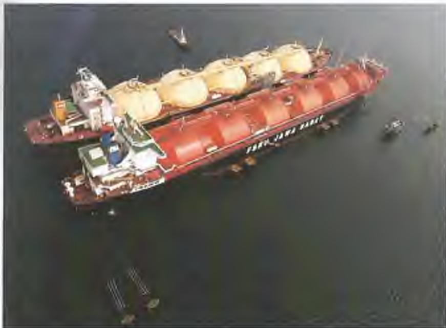
**Рис. 8. Отгрузка СПГ на плавучем терминале регазификации «FSRU JAWA BARAT»**
