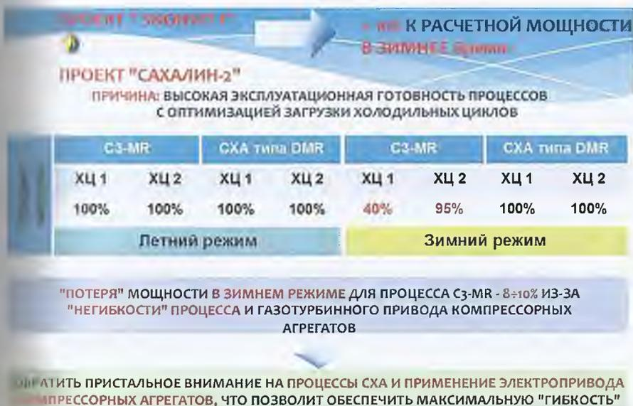
**Рис. 7. Влияние Арктического климата на потребность в энергии сжигания и производительность завода СПГ**
