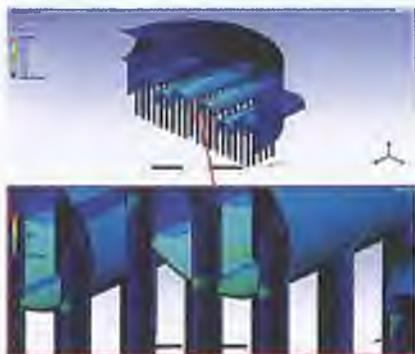
Рис. 6. Прочностные расчёты основного узла подвеса теплообменных труб реактора Фишера-Тропша
