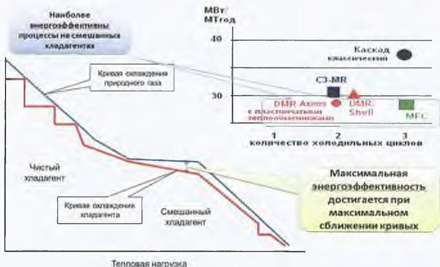
Рис. 2. Энергоэффективность процессов производства СПГ
