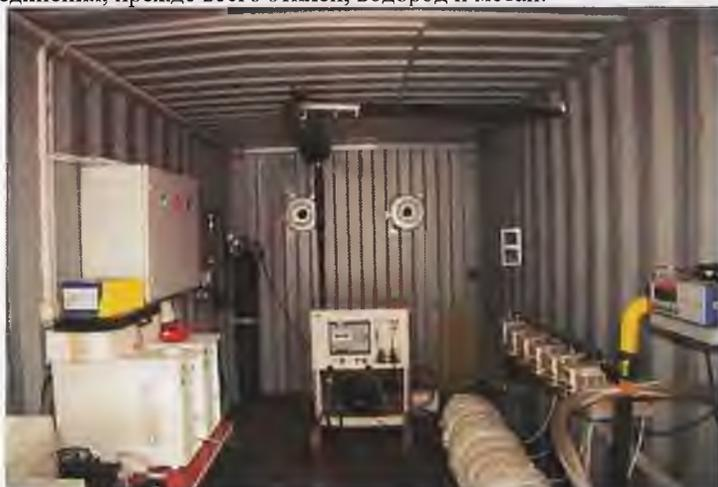
Рис. 5. Пилотная установка селективного оксикрекинга тяжелых компонентов ПНГ.
