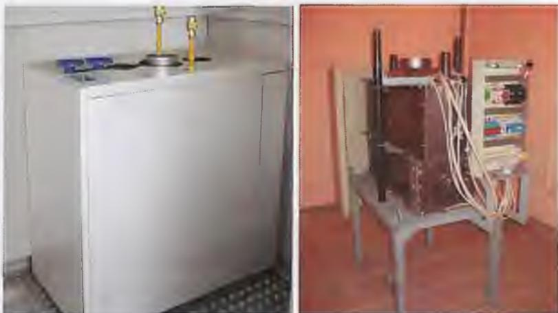
Рис. 9. Пилотный образец конвертера метановоздушной смеси в синтез-газ производительностью  $8 \text{ м}^3/\text{ч}$  по природному газу, разработанный в ИХФ РАН и ИПХФ РАН
