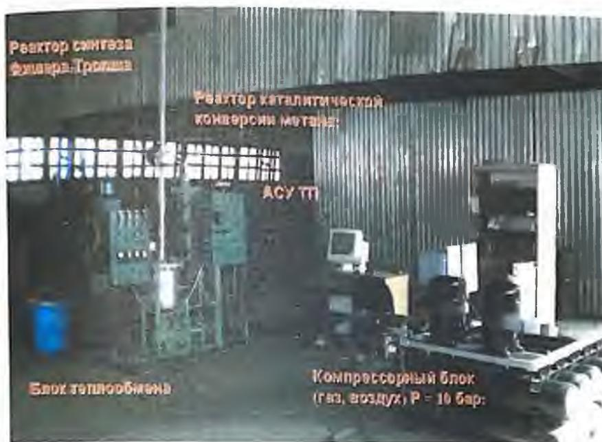
Рис. 5. Лабораторная установка для трехфазного синтеза Фишера-Тропша
