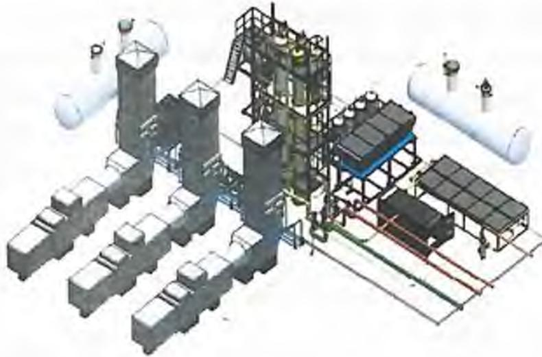
**Рис. 5. Блочно-модульные энергокомплексы переработки ПНГ**
