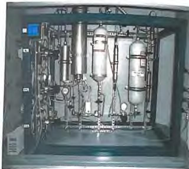
Рис. 2. Общий вид установки пароуглекислотной конверсии природного газа
