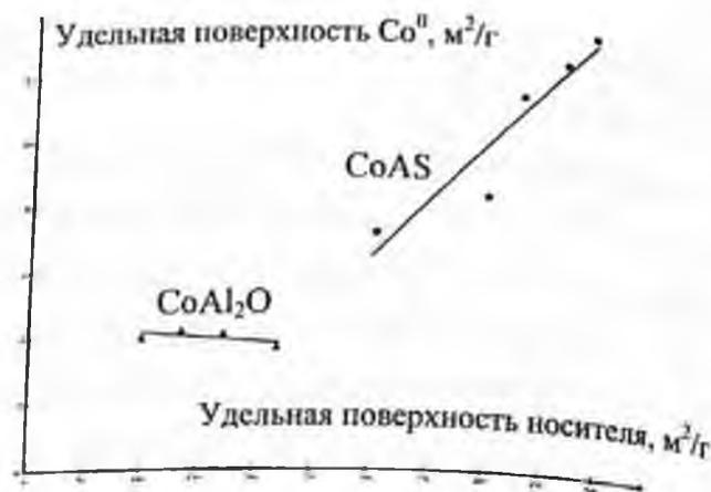
Рис. 7. Связь удельной поверхности  $\text{Co}^0$  с удельной поверхностью носителя
