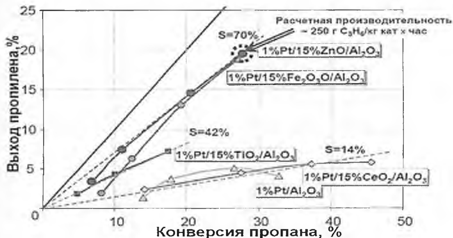
Рис. 7. Зависимость выхода пропилена от конверсии пропана
