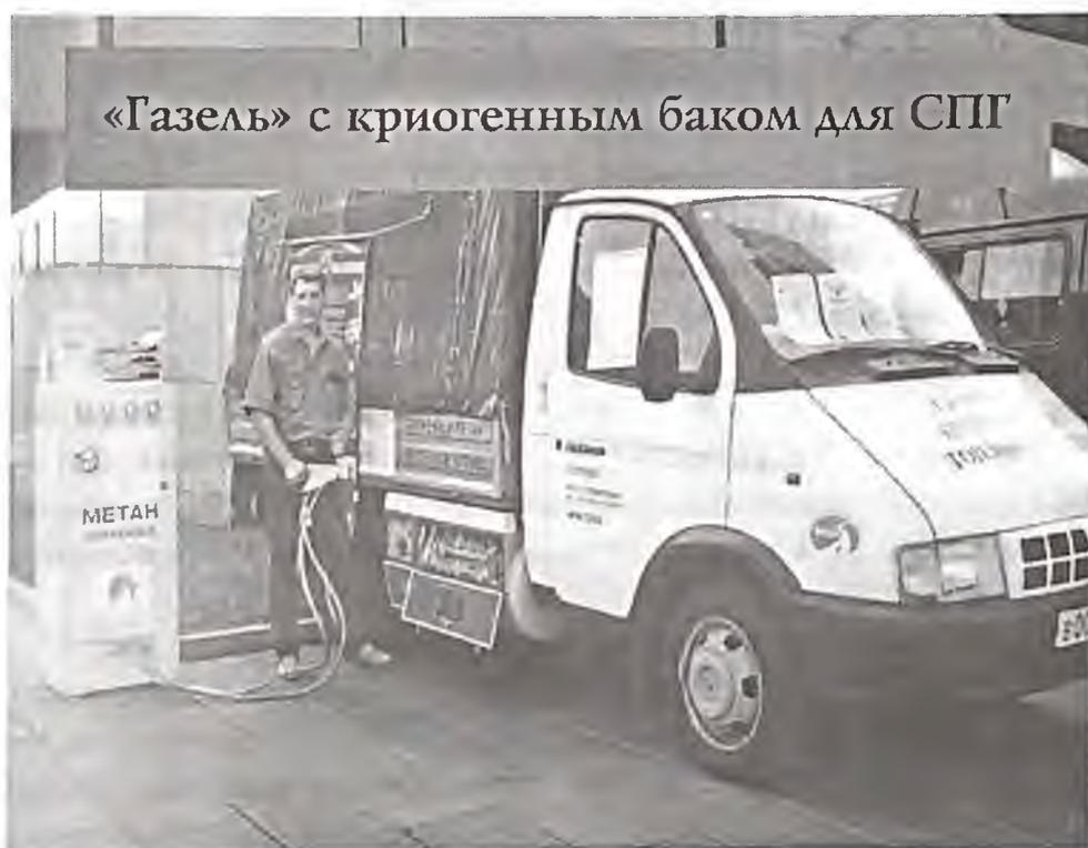
Проведены сертификационные испытания автомобиля, оснащенного этим оборудованием и работающего на СПГ, включая экологические и скоростные испытания и экспертизу безопасности. Получен сертификат, разрешающий использование указанного оборудования на автомобиле ГАЗ-3302 и его модификациях.
