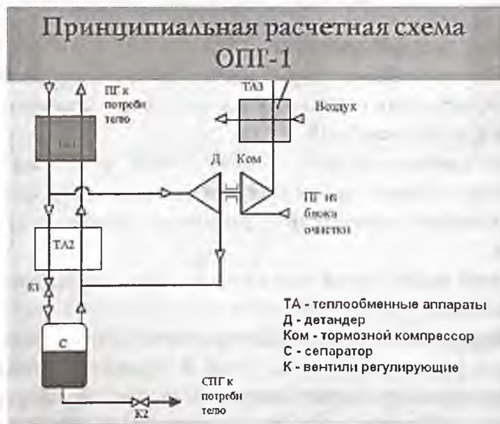
Сравнение различных схем сжижения по расходу энергии и составу оборудования позволяет рекомендовать для установок производительностью до 3000 кг/ч схему с детандером, работающую на разности давлений между магистральным и раздаточным
