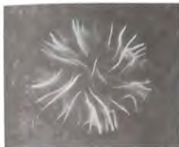
Рис. 2. Псевдокоронный микроволновый импульсно-периодический разряд (вид с торца)
