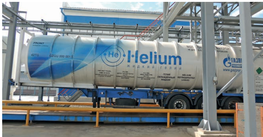
Рис. 6. Отечественные контейнеры-цистерны для транспортировки гелия, разработанные ОАО «НПО «Гелиймаш» [15]
