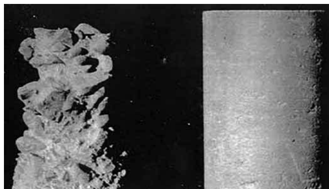
Сравнение сульфатостойкого бетона из портландцемента после трех недель воздействия 20%-й серной кислотой (слева) с серным бетоном после трех лет воздействия (справа) [1]
